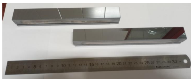
Рис.1. Фото рентгеновских зеркал на основе монокристаллического кремния для двухзеркального монохроматора (а) и нанофокусирующей системы (б) синхротрона СКИФ.
