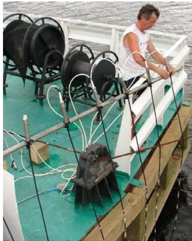
Монтаж системы из 8-ми 32-х канальных антенн с передачей цифровых данных по радиоканалу
