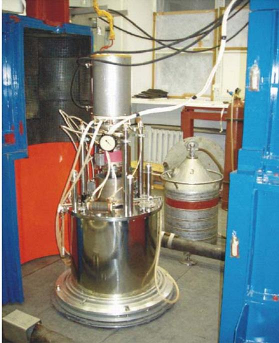
Рис.1. Фотография верхней части экспериментального стенда (450 кэВ; 180 А, 1 мкс, 0 – 10 Гц). Видны элементы биологической защиты, криомагнит и СВЧ калориметр.
