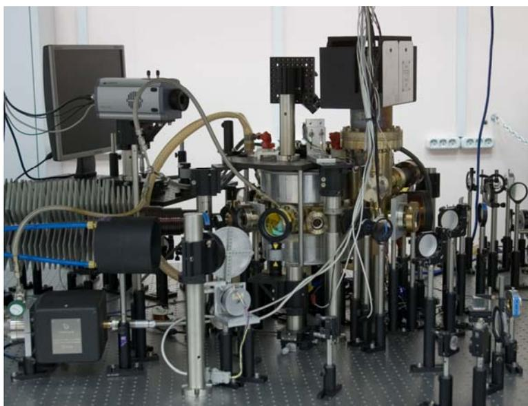
**Рисунок 2.** Фрагмент установки для лазерного пленения и охлаждения атомного газа
