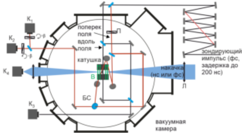
Рис. 5.4: Принципиальная общая схема экспериментов по лабораторному моделированию астрофизических явлений. (К2, К3) - ПЗС камеры интерферометров, (К1, К2) - ПЗС камеры поляриметрической диагностики, (БС) - делитель зондирующего излучения, (П) - поляризатор, (Л) - линза.
