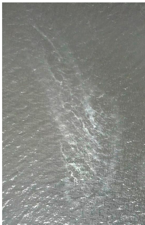
Рис. 1.18. Снимок плёнки олеиновой кислоты, полученный в ходе натурных экспериментов на Горьковском водохранилище с помощью БПЛА.
