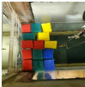
**Рис. 15.** Схема экспериментальной установки (слева): 1(а) – волнопродуктор, 1(б) – вентилятор, 3 – сетка, 4 – область, покрытая льдинами, 2 – два волнографа, 5 – камера. Справа – вид сверху на имитаторы льдин.
