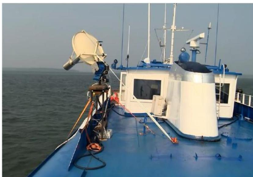
Рисунок 1.7 – Расположение КМРЛ на борту теплохода «Петр Андрианов»
