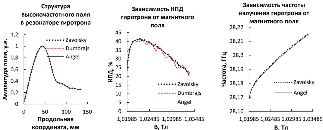
**Рис. 23.** Сравнение результатов расчета численного моделирования резонатора гиротрона с частотой генерации 28 ГГц, выполненных на авторских кодах Н.А.Завольского (черный пунктир), О.Думбрайса (красная штрихованная) и программы Angel (черная линия).
