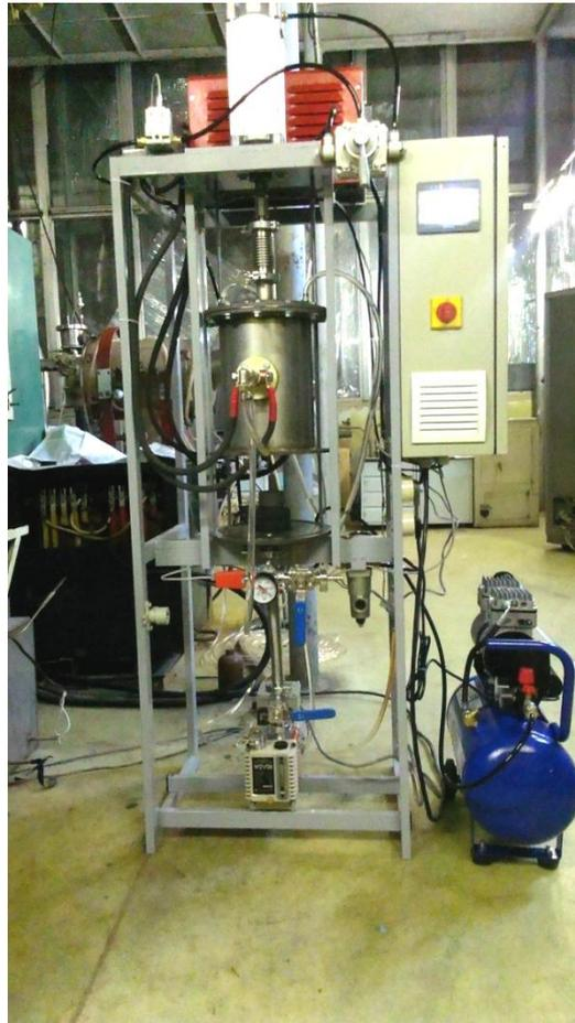
Рис. 42. Вакуумная печь с функцией прессования
