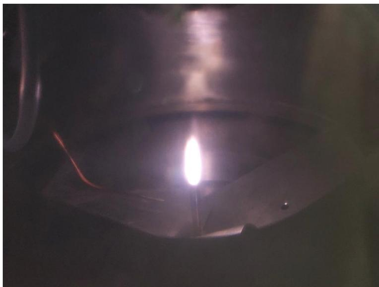
Рисунок 2.4. Фотография плазменного факела, поддерживаемого в квазиоптическом пучке субтерагерцового излучения гиротрона с частотой 263 ГГц. Время выдержки 0.1 с.
