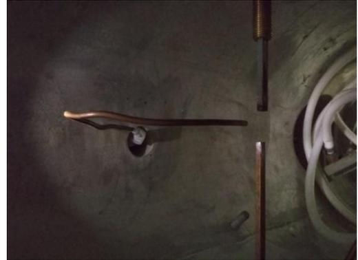
Рисунок 1.33. Фотографии экспериментального стенда. Измерение средней электронной плотности в плазменном факеле методом СВЧ зондирования
