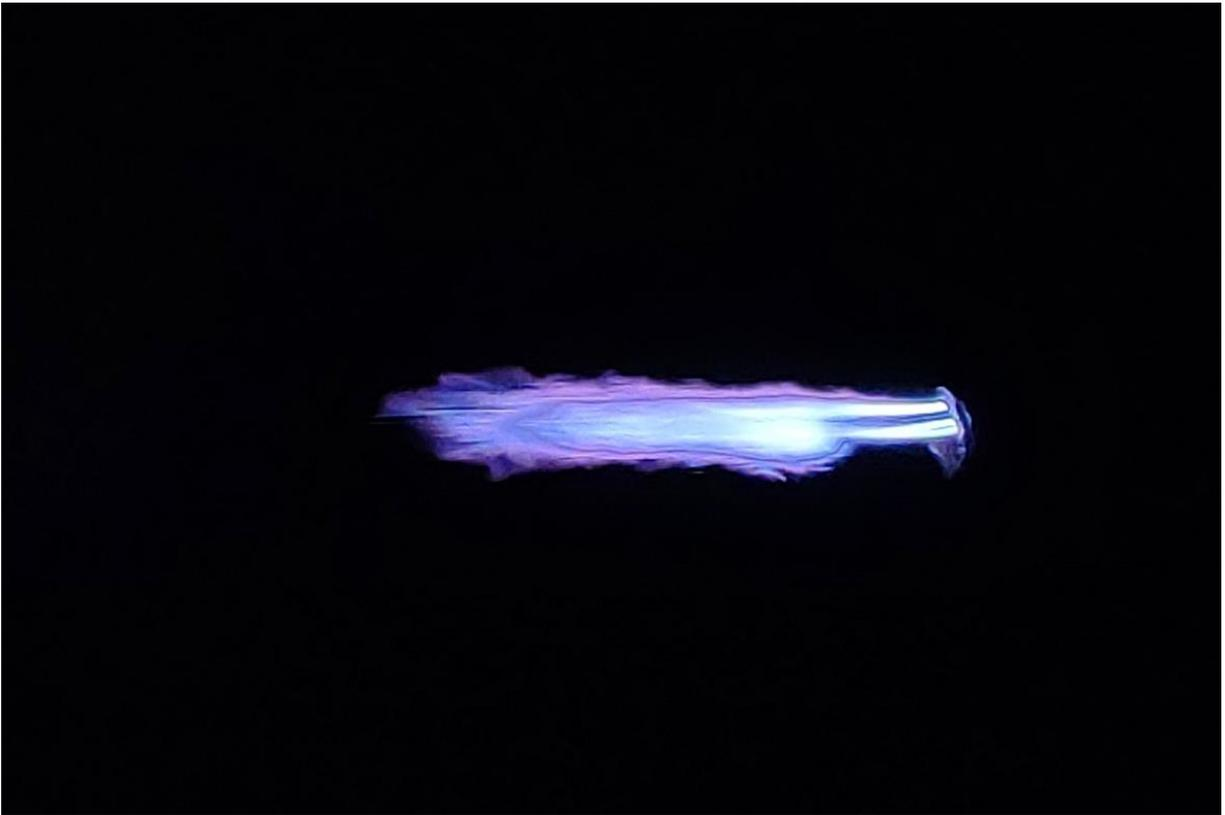
Рисунок 1.26. Фотография плазменного факела в режиме с большой скоростью прокачки аргона (>30 л/мин).
