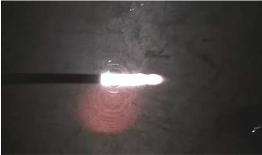
Рисунок 1.8. Фото факела, поддерживаемого сфокусированным излучением гиротрона с частотой 24 ГГц. Направление распространения СВЧ слева направо. Время экспозиции 0.1 с.
