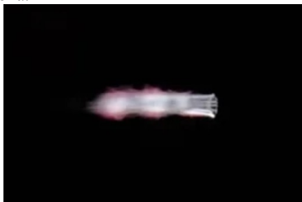
Рис. 2. Фотография плазменного факела, поддерживаемого в сфокусированном квазиоптическом пучке миллиметрового излучения с частотой 24 ГГц. Мощность нагрева 1500 Вт, скорость потока аргона 15 л/мин. Время экспозиции 1 мс.
