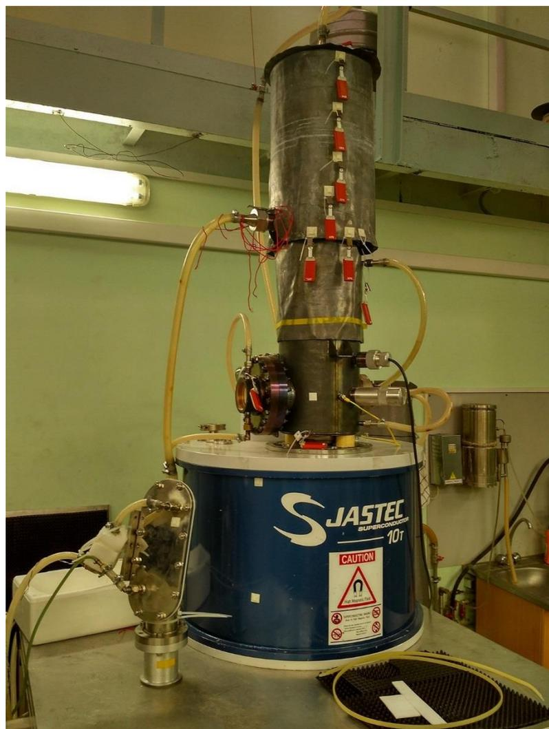
*Рисунок 2.1.8: Общий вид гиротрона в криомагните*
