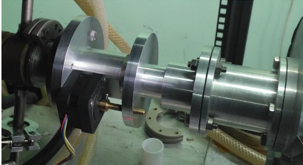
*Рисунок 1.1.9: Подвижный моторизованный отражатель*
