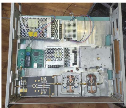
Рисунок 24.10 - Вид задающего генератора, собранного в корпусе
