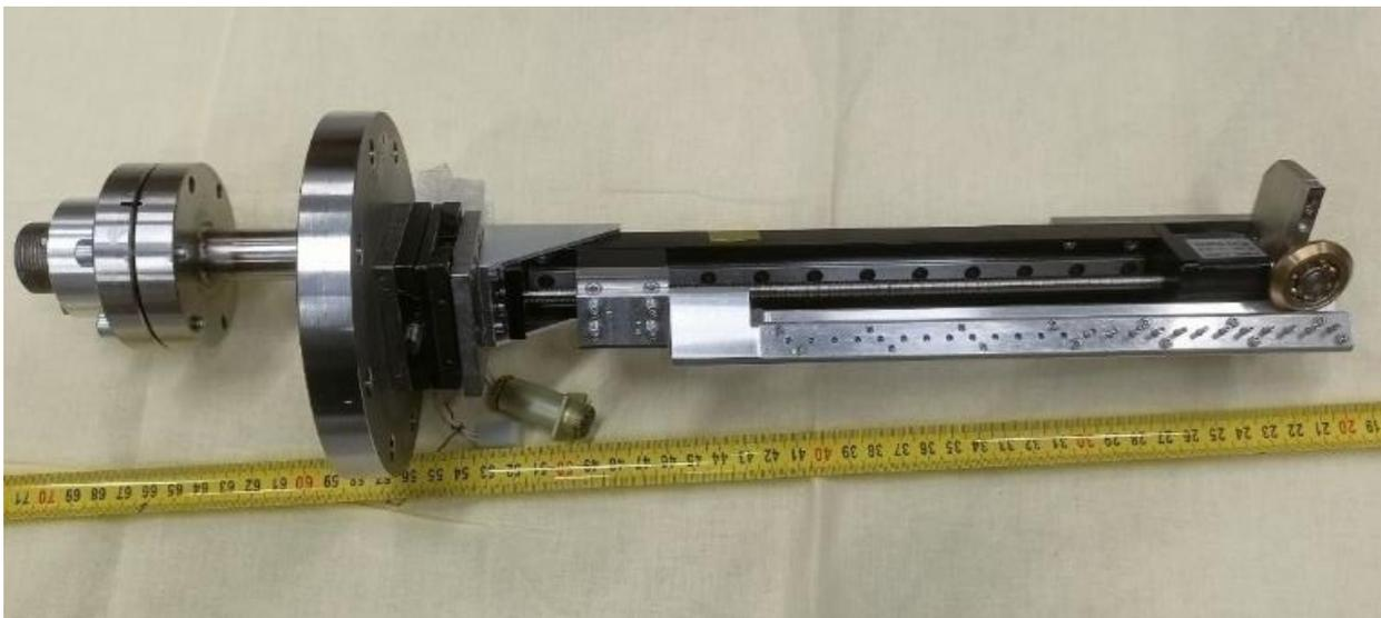
Рисунок 15.5 - Узел подачи мишеней с моторизованным линейным транслятором
