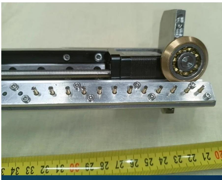
Рисунок 15.14 - Узел подачи мишеней с установленными на нем капсульными мишенями
