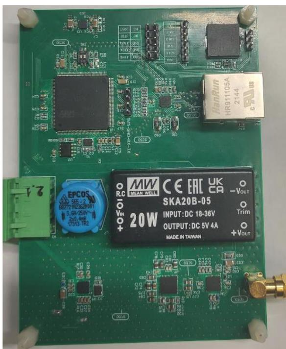
Рисунок 24.1 - Плата СВЧ генератора
