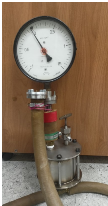
Рисунок 22.2 - Стенд для испытания мишеней перепадом давлений
