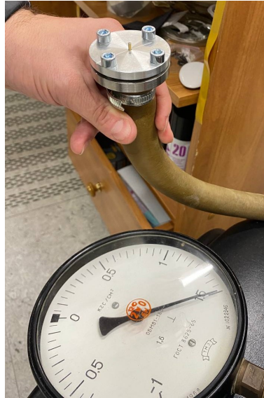
Рисунок 22.3 - Фотография стенда с образцом и поданным давлением на уровне 1.5 атм
