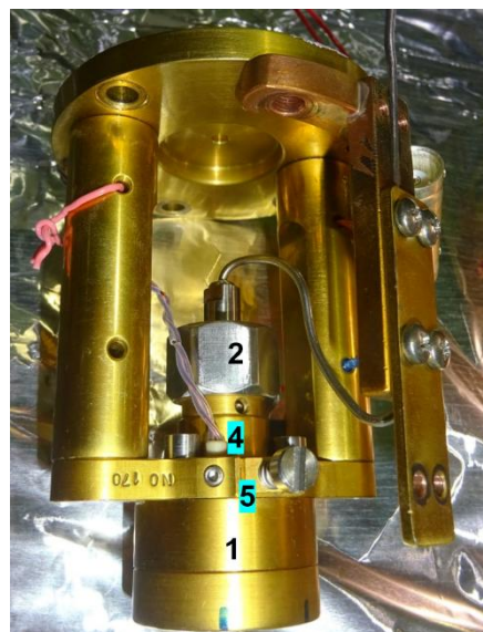
Рисунок 16.1 — система импульсного напуска газа в вакуумный объем с подсистемой варьирования температуры: 1 — корпус электромагнитного клапана; 2 — линия подвода рабочего газа; 3 — элементы Пельтье; 4 — линия электропитания втягивающей катушки клапана; 5 — термопара; 6 — холодный «палец» криорефрижератора
