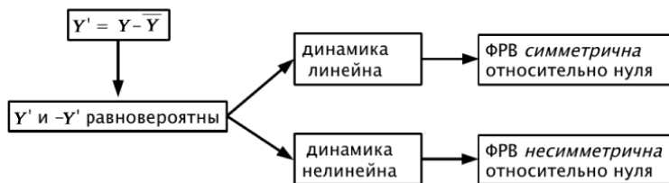
Рис. 2. Схема диагностики вклада нелинейных межволновых взаимодействий, основанная на оценке характеристик ФРВ для погодной переменной Y [18, 19]
