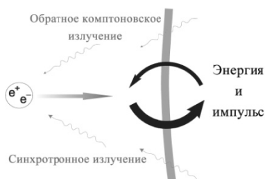
Рис. 4. Перенос энергии и импульса в модифицированной релятивистской ударной волне
